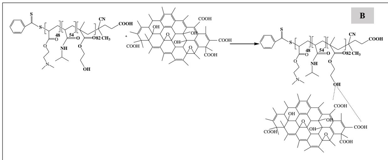
Scheme 1- Synthesis of A) poly(HEMA-*b*-NIPAM-*b*-DMAEMA) copolymer, and B) GO/poly(HEMA-*b*-NIPAM-*b*-DMAEMA) nanocomposite
