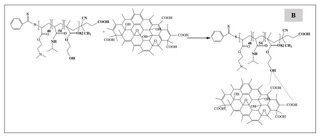
Scheme 1- Synthesis of A) poly(HEMA-*b*-NIPAM-*b*-DMAEMA) copolymer, and B) GO/poly(HEMA-*b*-NIPAM-*b*-DMAEMA) nanocomposite
